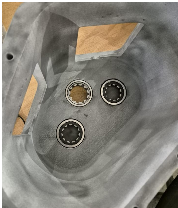
Obrázok 5 Uloženie troch valivých ložísk v hlavnom obale prototypu
