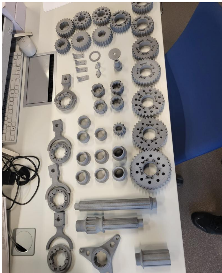
Obrázok 3 Súbor hlavných prototypových dielov pred montážou
