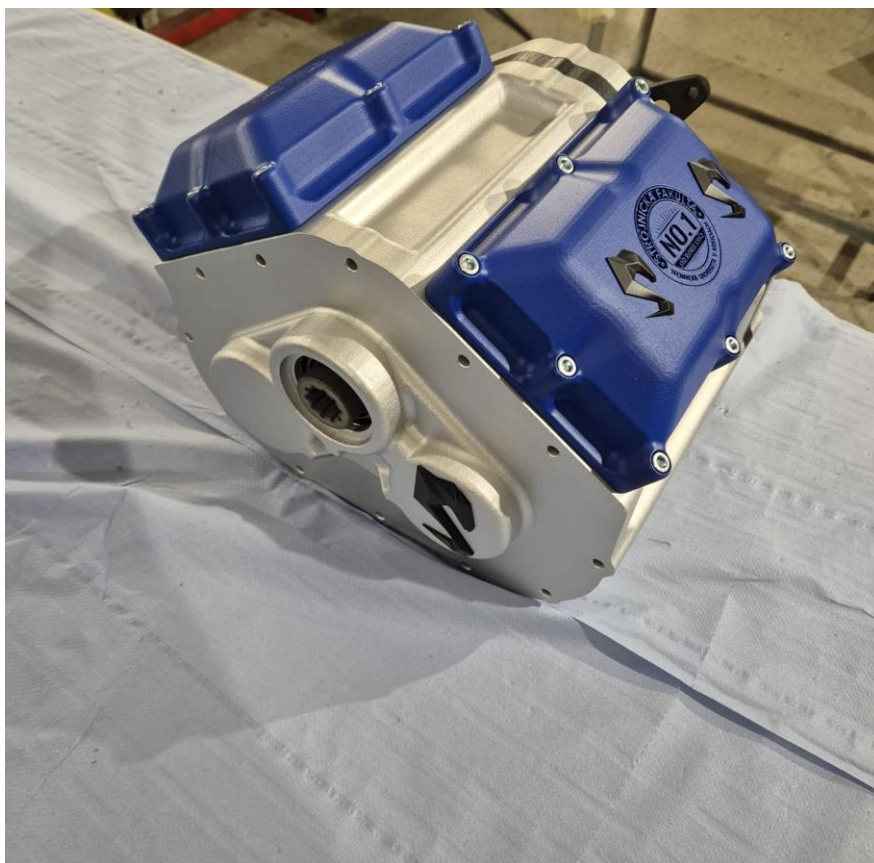
Obrázok 8 Dokončený fyzický prototyp trojhriadeľovej sekvenčnej prevodovky
