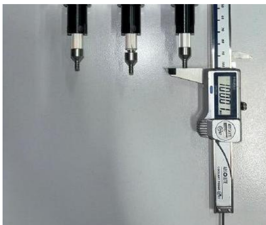
Obrázok 5 Rozdiel neutrálnej polohy pri troch lineárnych aktuátoroch
