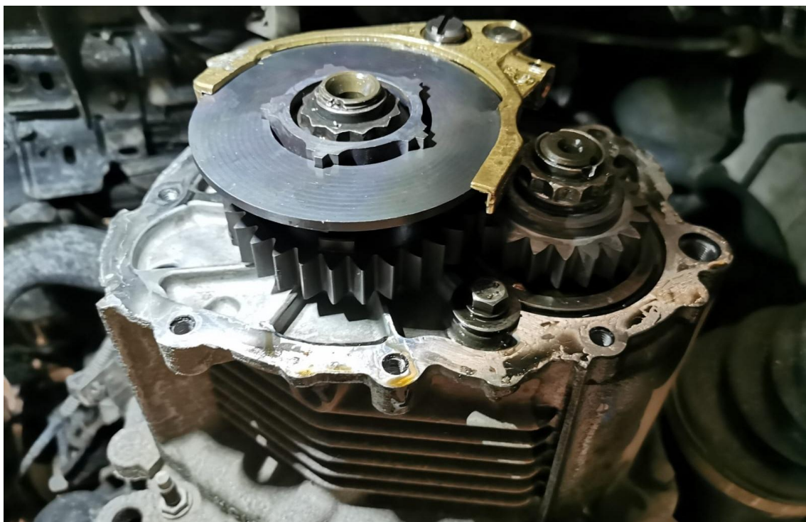
Obrázok 5 Skúšobná montáž ozubených komponentov v prevodovej zostave
