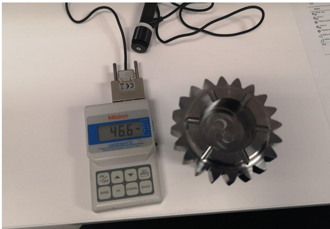
Obrázok 4 Odčítanie 46,6 pri meraní ozubeného komponentu
